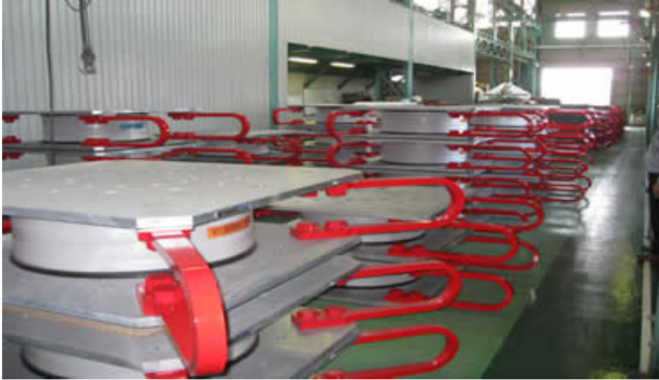
5月18日（仮称）久喜総合病院に取り付けられる免震装置です。
